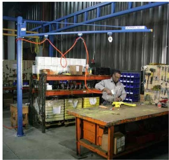
Le TSJ50 est conçu pour un mouvement facile et des charges légères. Son style de connecteur de balancier léger permet d'avoir un mouvement facile et une haute performance sans vous donner plus que ce dont vous avez besoin d'une grue pour des applications de faible capacité.
