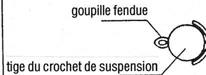
Fig. 5-5 Pliage de la goupille fendue
